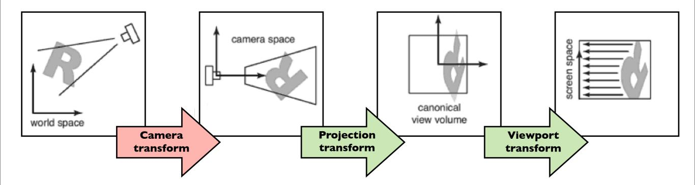
How do we specify the camera configuration? (orthogonal case)
