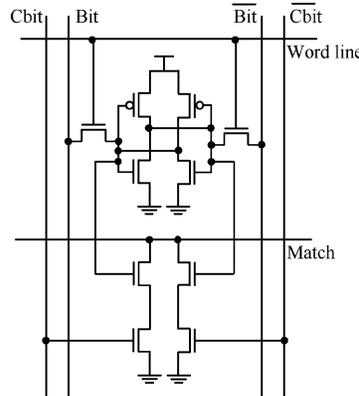
Fig. 25. CAM cell circuit.
