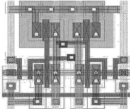
Fig. 26. CAM cell layout.
