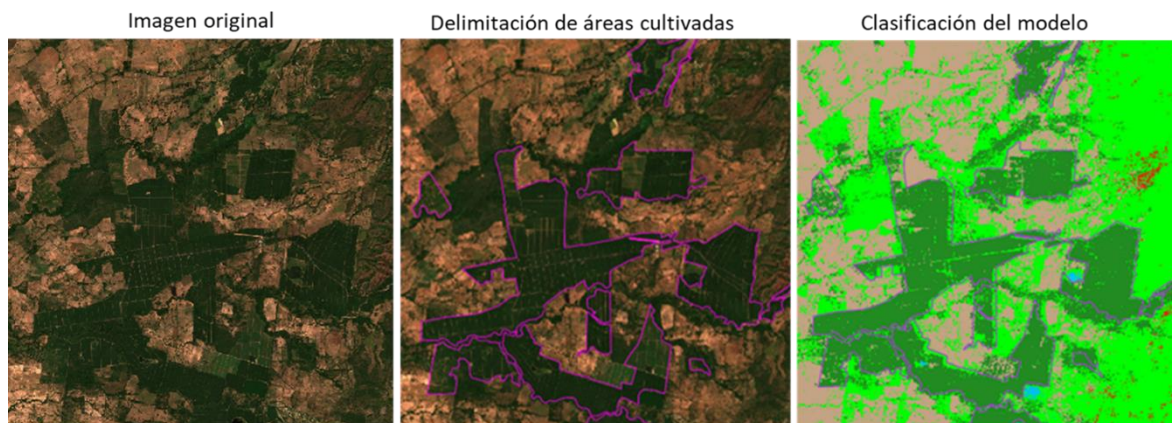
Figura 2. Clasificaciones realizadas por el modelo XGBoost. La segunda imagen muestra delimitadas las plantaciones de palma de aceite para la primera imagen. En la tercera se puede observar las zonas, en verde oscuro, que el modelo identifica como plantaciones de palma de aceite.
