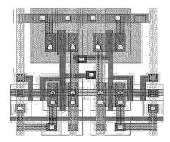
Fig. 26. CAM cell layout.
