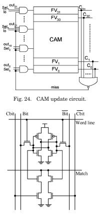
Fig. 25. CAM cell circuit.
